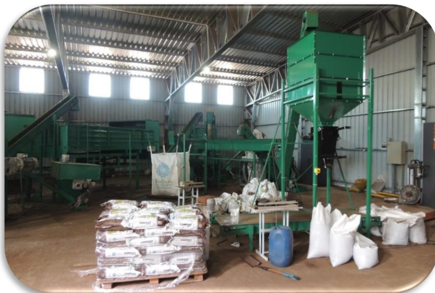
Figura 3: Nueva línea de peletizado de compost y formulación de sustratos instalada en BioTerra (febrero 2018).
